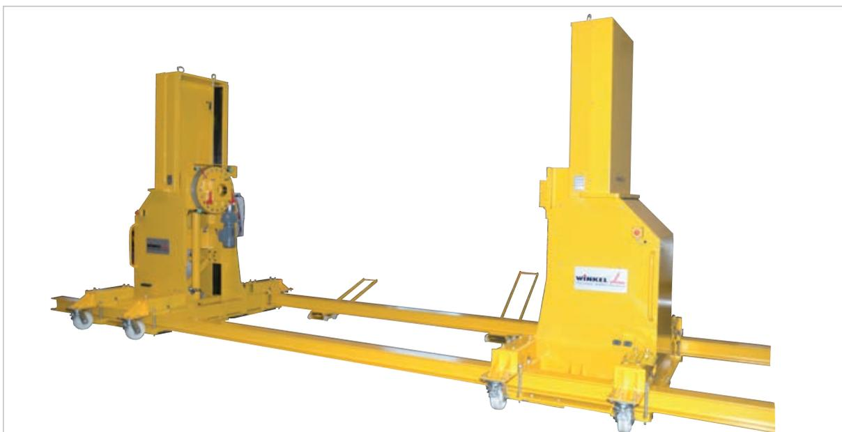
Unidad de elevación y giro para operaciones de soldadura
