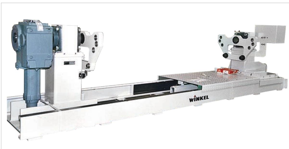
Dispositivo de volteo para desmoldado de piezas de fundición mediante un robot industrial
